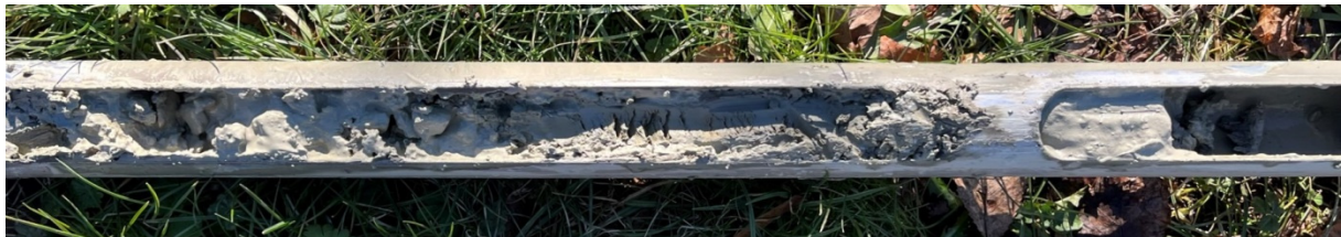
Bild 2: Verwitterungslehm/-schutt von Kalkstein, RKS 4
