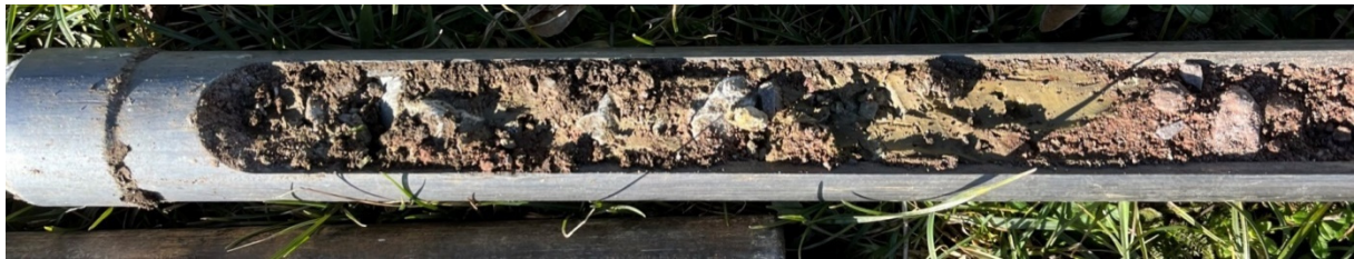
Bild 1: Aufgefüllter Kies-/Lehmboden, RKS 3
